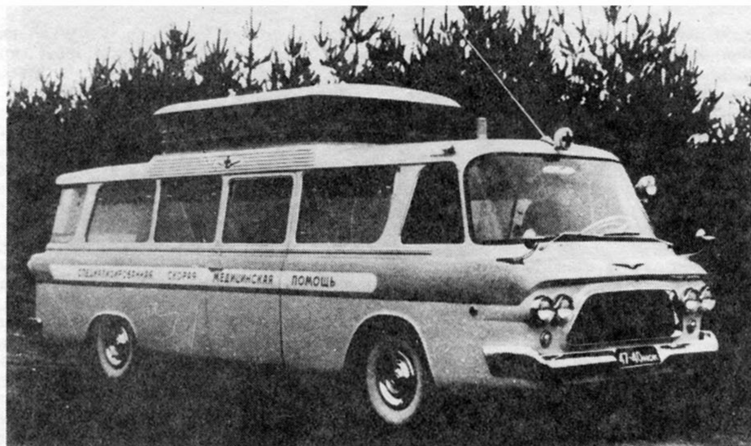
Передвижная операционная машина ЗИЛ-118А 1964 г. в Минздраве, с подъемной средней частью крыши
