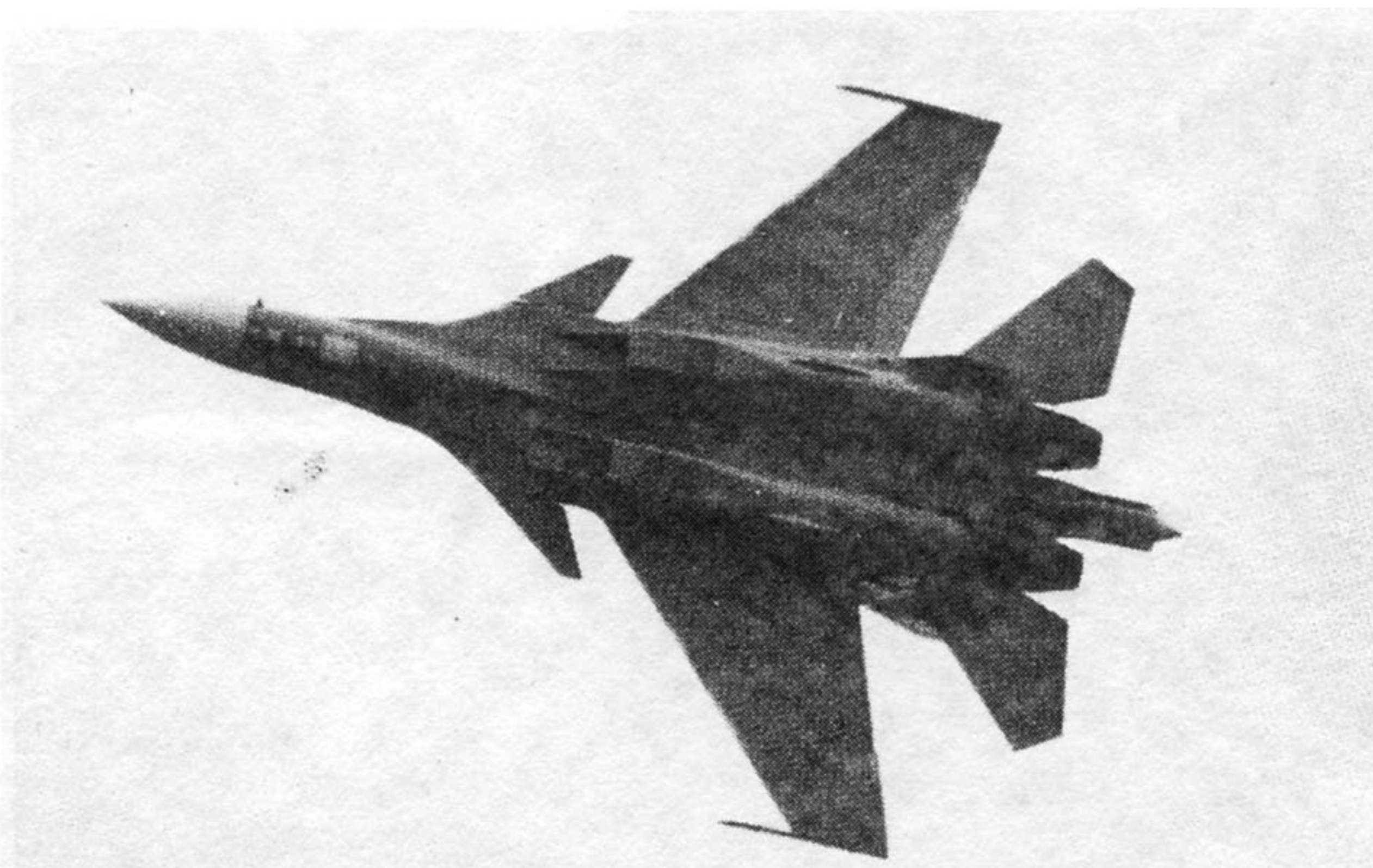
В полете Су-35 отчетливо видны поверхности переднего горизонтального оперения
